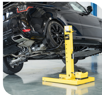
Sollevamento su ruote posteriori Lifting on the rear wheel
