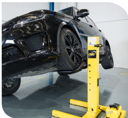
Sollevamento su ruote anteriori Lifting on the front wheel
